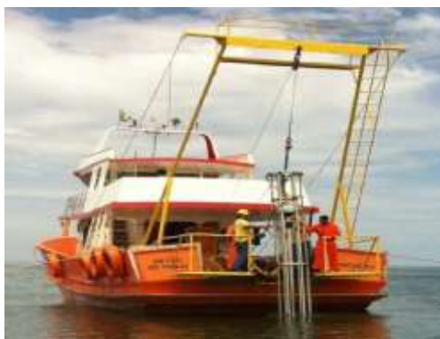
Figura 3: Içamento do Vibracore do mar, após a realização da amostragem (Geodrill, 2013)
