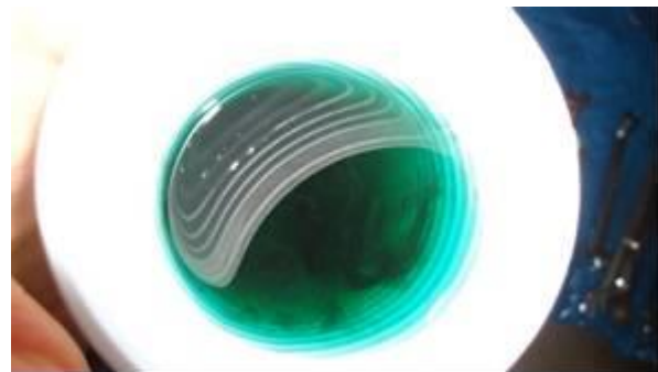
Figura 8. Detalhe do óleo da bomba peristáltica após 8 meses de operação
